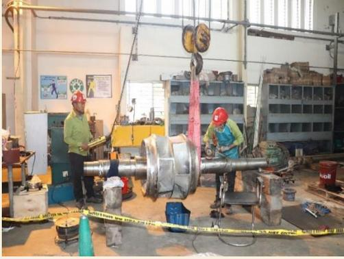
Figure 5.6. CW Pump এর Overhauling কার্যক্রম এবং reinstallation এর কিছু চিত্র।
