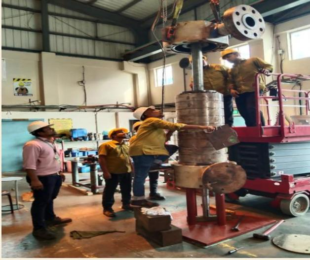
চিত্র-৪.১ : HP BFP পাম্পের Overhauling ।
