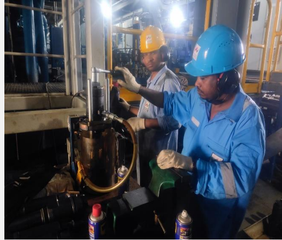
চিত্রঃ Fuel injection valve সিলিন্ডার থেকে তুলে pressure test করা হচ্ছে
