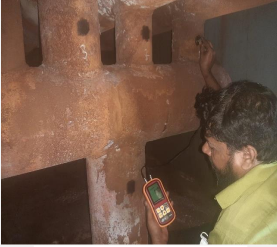
চিত্র ২.৭: Tube- এর Thickness measurement
