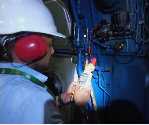
চিত্রঃ Engine এর Charge Air Bypass Valve Actuator Check করা হচ্ছে
