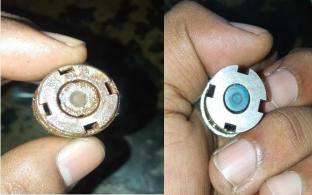
চিত্রঃ Start Air Solenoid Valve Plunger Cleaning এর পূর্বে ও পরে
