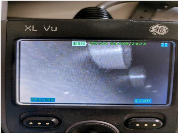
চিত্র ২.৯: HRSG-এর Borescope inspection
